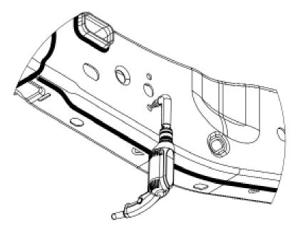
USE ANGLE DRILL ATACHMENT TO DRILL AT MARKED LOCATION S
